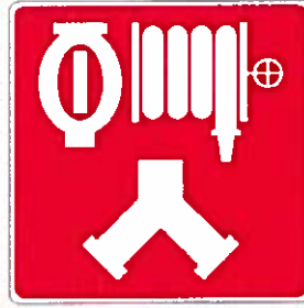
Raccord-pompier alimentant le système de gicleurs et les canalisations incendie (colonne montante)
