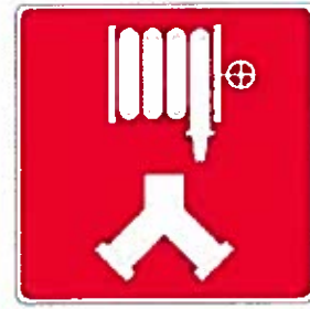
Raccord-pompier alimentant les canalisations incendie (colonne montante)
